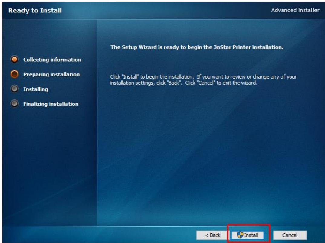
6. Nos solicitará permisos para ejecutar el instalador, indicamos **Si** y comenzará el proceso de instalación. Una vez finalizado verificamos que esté marcada la opción **Launch 3nStar Printer** y pulsamos **Finish**:
